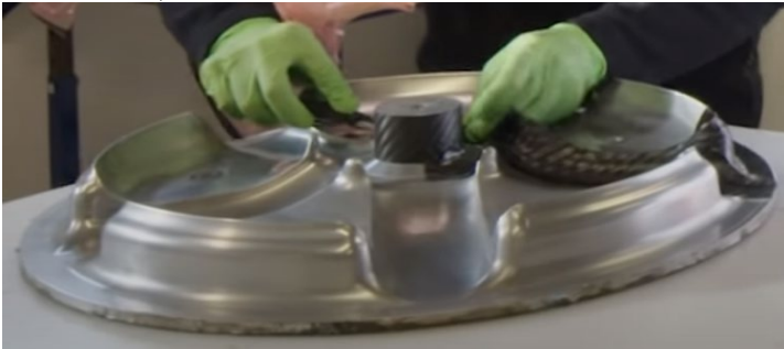
Рис. 1. Приклад використання металевої матриці для конструкцій з препрегу.
